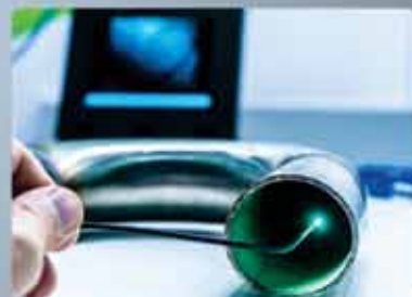
Boroscopia para comprovar a qualidade da solda. Ensaio por líquido penetrante.
