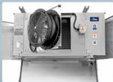
Ventilador escamoteável, acesso ao núcleo. Tampas laterais e bandeja basculantes. Carenagem 100% aço inox. Aletas do núcleo em Alumínio Naval. Indicações atendendo NR12.
