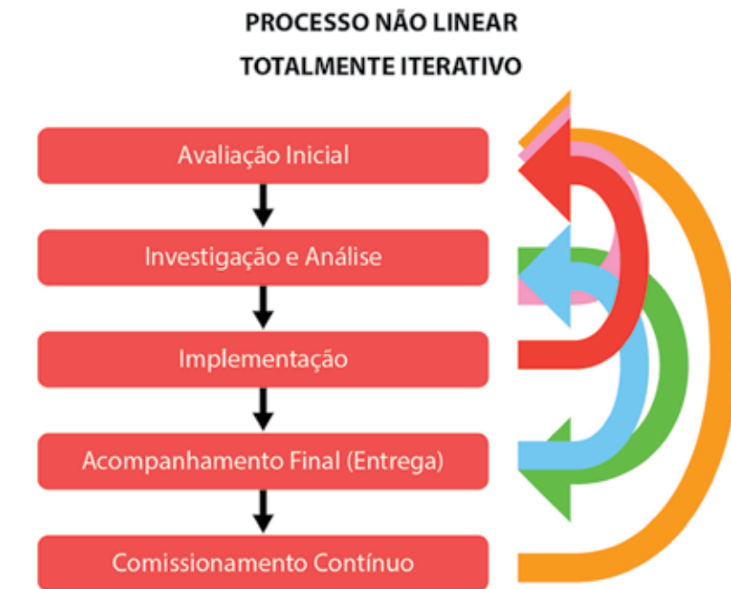
Figura 1 – Fluxograma das atividades do processo de retrocomissionamento e suas iterações.
