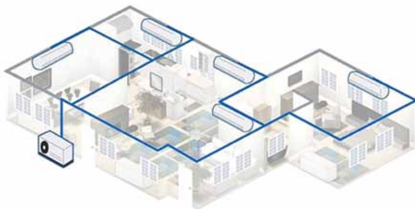
Figura 1. Sistema de climatização Multi Split
